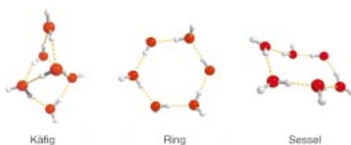
Abbildung 21. Experimentell beobachtete Wasserhexamere: die in der Gasphase detektierte Käfigstruktur, [146] die in flüssigem Helium vorliegende quasiplanare Ringstruktur [147] und die in organischen Wirten auftretende sesselförmige Ringstruktur. [148]
